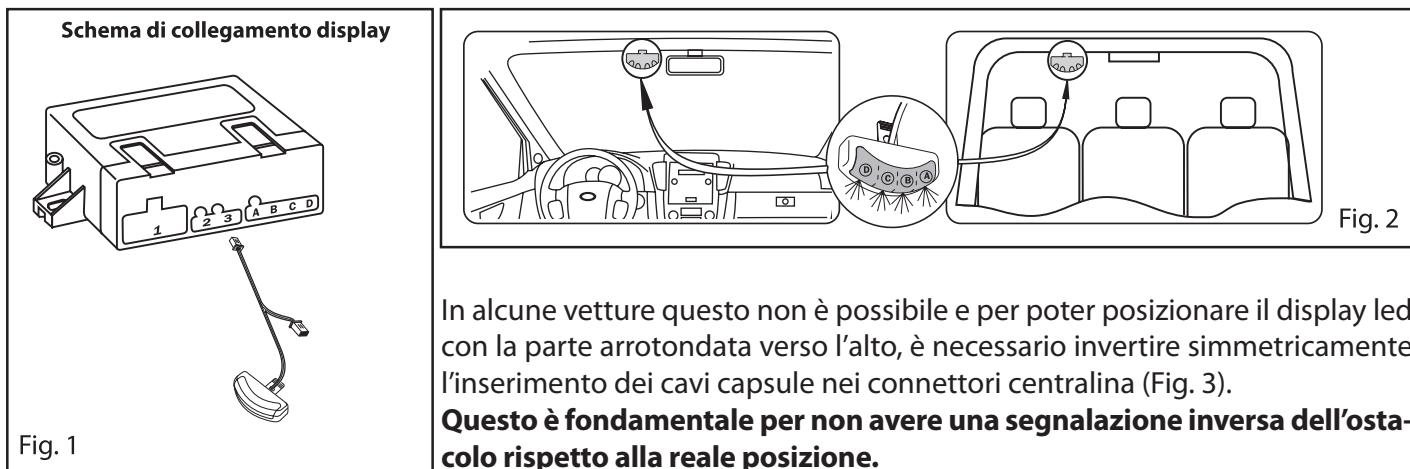
In alcune vetture questo non è possibile e per poter posizionare il display led con la parte arrotondata verso l'alto, è necessario invertire simmetricamente l'inserimento dei cavi capsule nei connettori centralina (Fig. 3).
